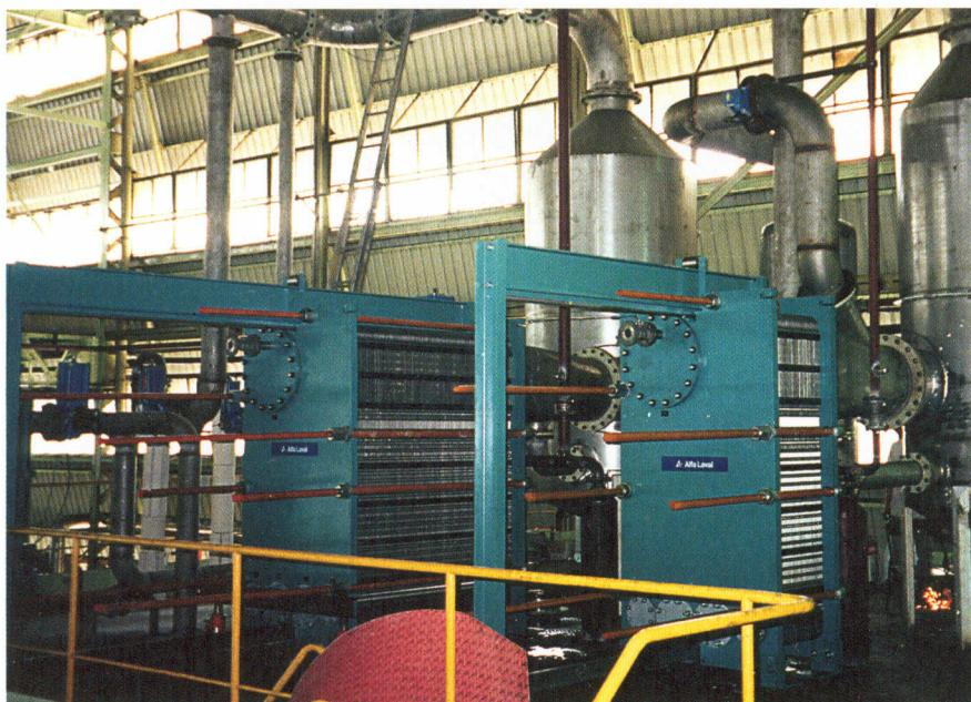
マレーシアの砂糖精製所の二重効用 TVR システムで使われているAlfaVap。従来の流下液膜のシェルアンドチューブ式システムでは、糖度71ブリックスまでしか糖蜜を濃縮することができませんでした。AlfaVapを使用したシステムでは、ワンパスでも75ブリックスまでの濃縮が可能なので、滞留時間を大幅に短縮することができました。その結果、製品の品質も向上し、また、起動・停止の作業も容易になって、素早く行えるようになりました。
